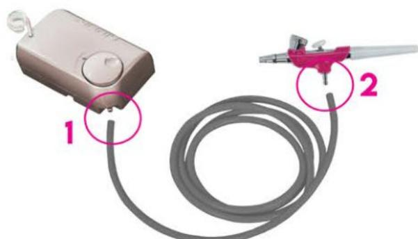
Nasadte jeden konec hadice z boku kompresoru. Druhý konec hadice spojte s pistolí dle obrázku. Není potřeba s hadicí otáčet, jednoduše ji nasuňte na spodní část pistole. Pomocí adaptéru propojte kompresor s elektřinou. **Kompresor je plně nabitý, jestliže se LED světlo na napájecím adaptéru rozsvítí zeleně. Odpojte kompresor od elektřiny.**
